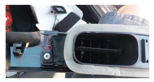
Nun musst du den Frontrahmen der Klimablende von der rückseitigen Luftführung trennen. Hierzu müssen alle Clips oben und unten sowie jeweils 2 auf den Seiten mit einem Schlitzschraubendreher angehoben werden bevor der Frontrahmen getrennt werden kann um die Lamellen freizulegen.
