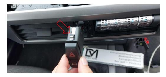
Im Anschluss musst du die Kabel des Warnblinkerschalter abziehen. Dazu muss die Lasche nach unten gedrückt werden, und der Stecker kann gelöst werden.
