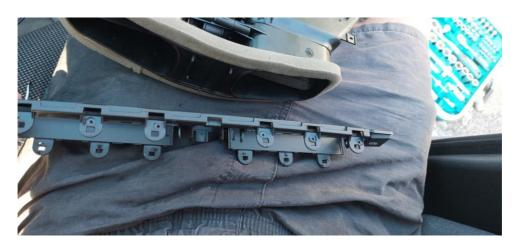
Nun musst du auf der Seite, in der später das MFD28 verbaut werden soll, Löcher gebohrt werden um die Kabel anschließend hindurchzuführen. Am besten bohrst du auf der Unterseite 2 10mm Löcher relativ dicht nebeneinander und kannst anschließend den Steg zwischen den Löchern mit einer Kneifzange entfernen und mit einer Feile zu einem Langloch ausarbeiten, sodass die beiden Molex Stecker durch das Loch passen. Das Ganze kann dann in etwa so aussehen:
