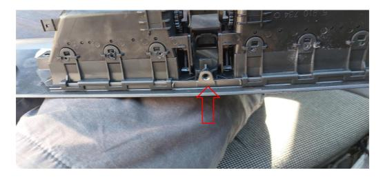
Dann die beiden 10mm Mutter abschrauben seitlich der Klimablende lösen und danach kann die Klimadüse von der Blende getrennt werden.
